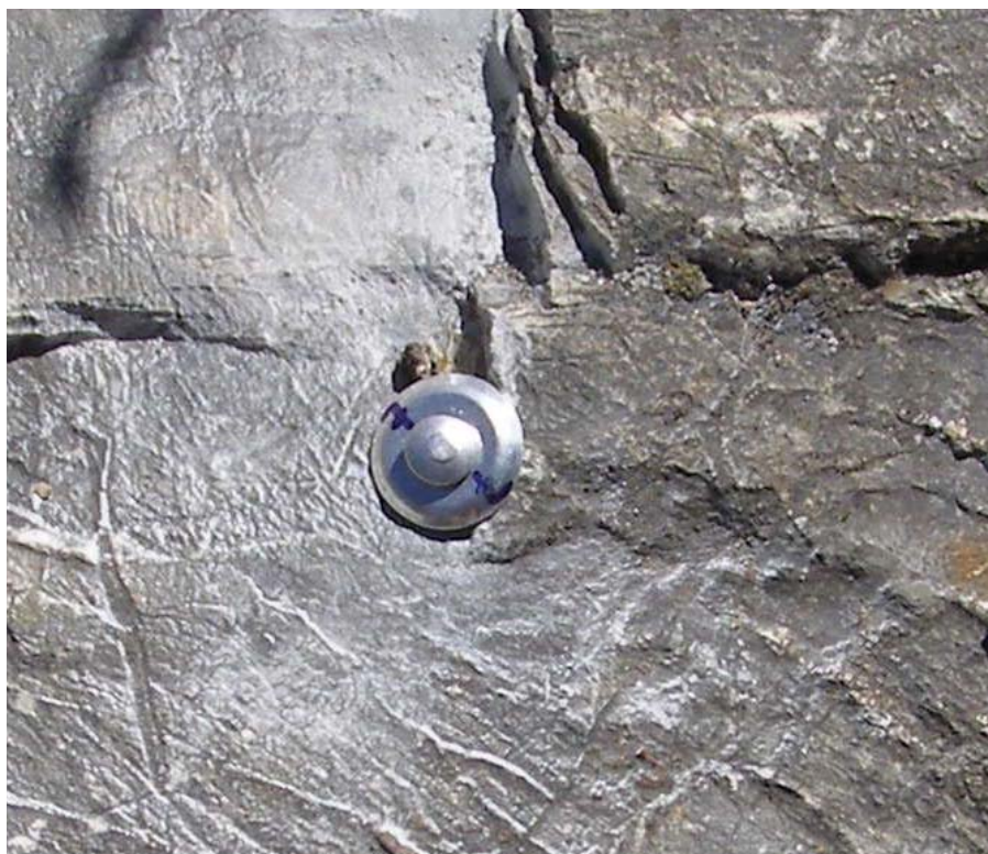
Fig. 7.22 Ejemplo de clavo de señalización de la estación, con indicación de su número.
