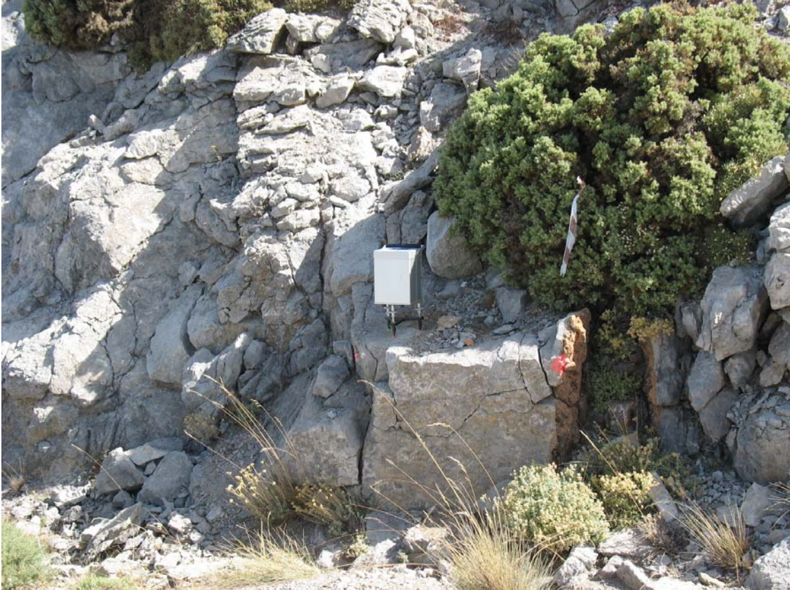
Fig. 7.19 Ejemplo de señalización en el itinerario realizado hacia el Puerto de los Pilonos (estación 30). Es uno de los casos en que esta posición sería inaceptable en gravimetría ordinaria.
