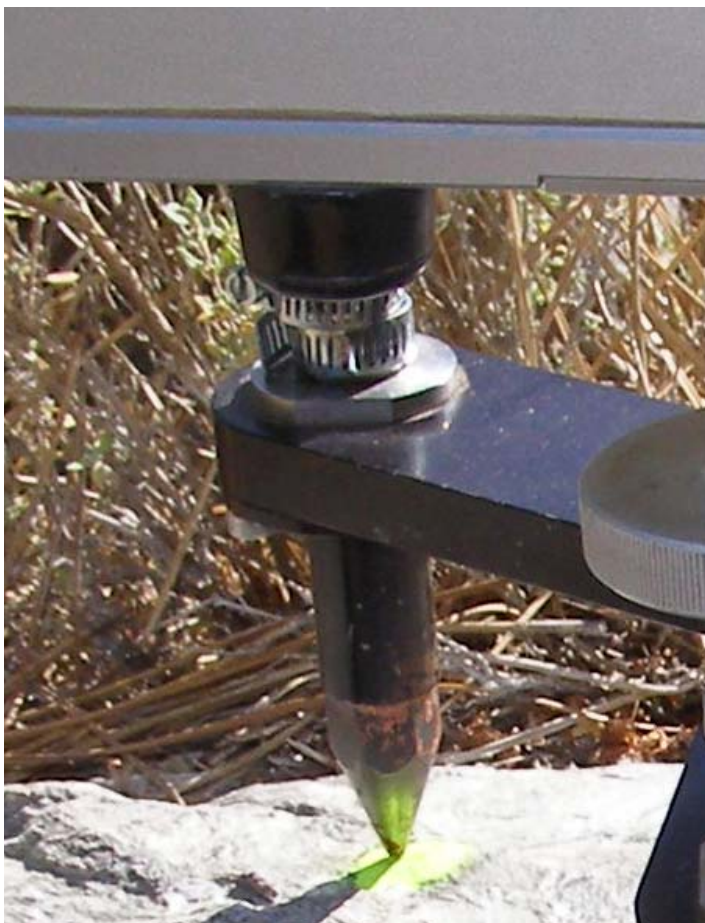
Fig. 7.24 Detalle de la pata del trípode que ha sido bloqueada para impedir la variación de altura del sensor del gravímetro en las diferentes mediciones.
