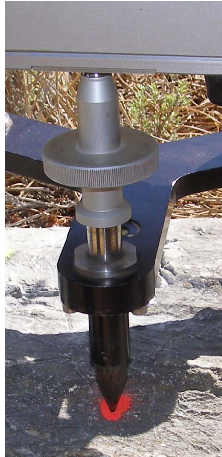
Fig. 7.24 Detalle de la pata del trípode que ha sido bloqueada para impedir la variación de altura del sensor del gravímetro en las diferentes mediciones.
